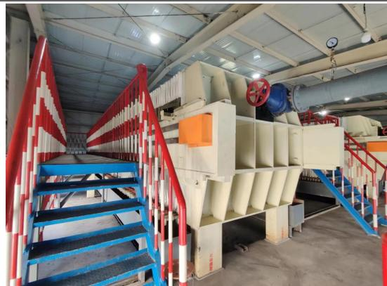
压滤机噪声基础减震
