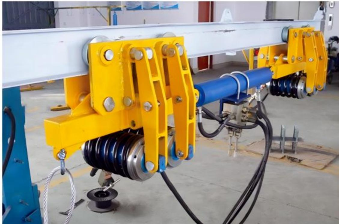
近日，小庄矿引进DY90/20单轨液压移动装置，进一步规范了40307工作面远距离供电电缆的拉移、吊挂、临时储存等工作流程，提高了作业期间安全保障水平，降低了职工劳动强度。
