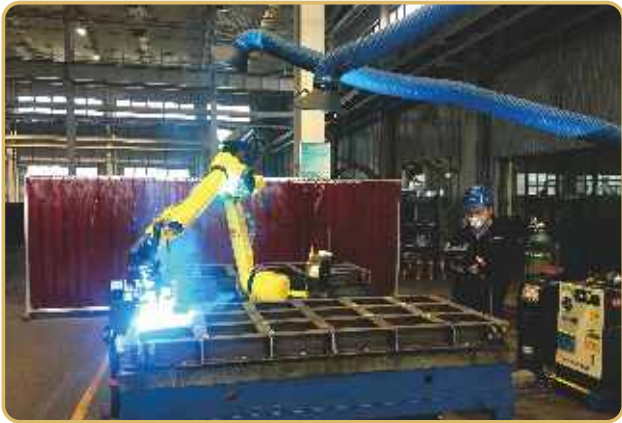
生产服务中心引进自动焊接机器人
