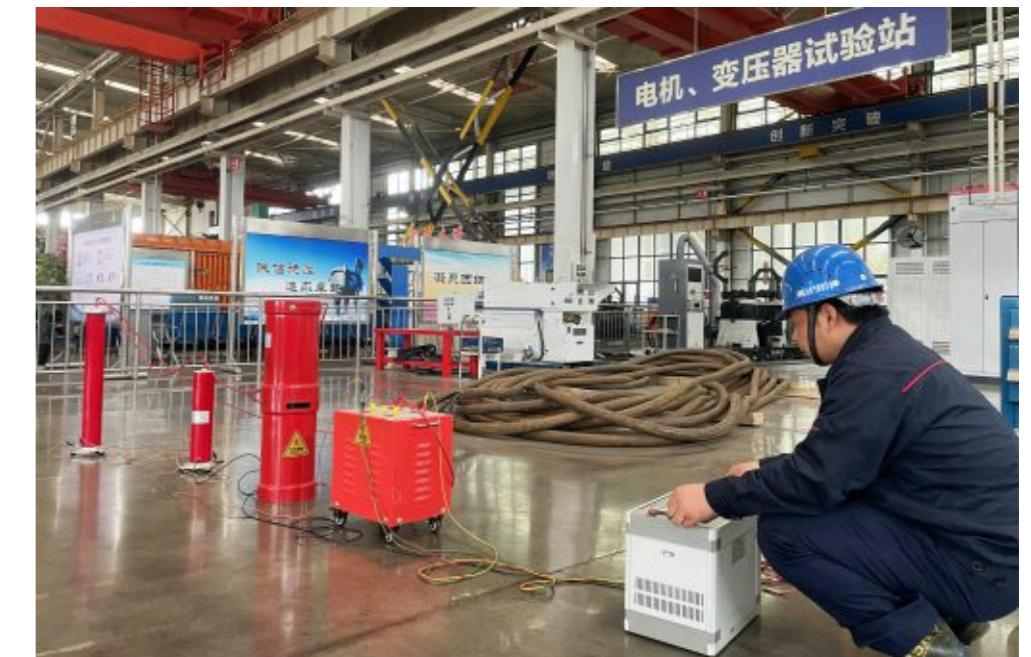
近日，生产服务中心创新研究“真空充气吸湿+梯度升温电热驱水”维修工艺，成功修复因泡水受潮导致绝缘性能劣化的10KV高压电缆，为矿山高压电缆的高效、经济修复提供了全新的解决方案。
