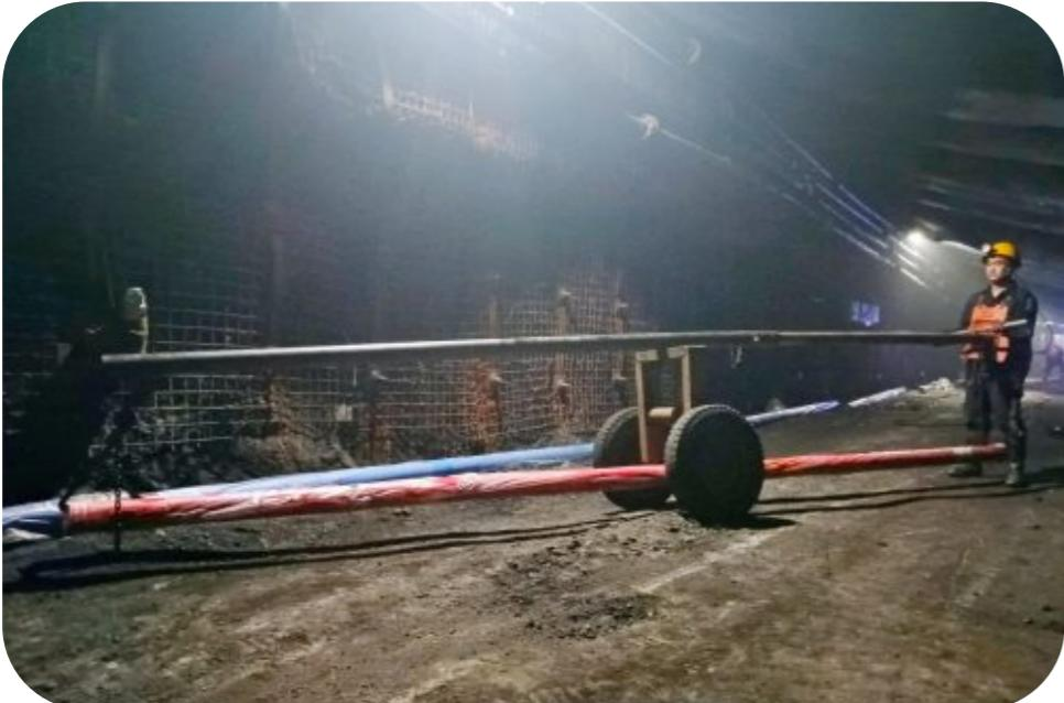
为进一步提升工作效率，减轻职工劳动强度，近日，文家坡矿生产准备队根据生产实际需求，自制管路搬运车，为安全生产注入新动能。
