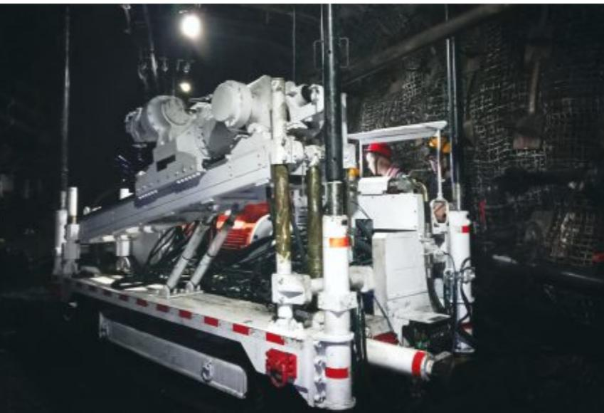
把……”截至3月初，该矿综掘五队已修复锚杆机10台、风煤钻14台、风镐20把、风泵7台、锚索张拉千斤顶23台，节约创效15余万元。作为井下巷道补强支护的主要工具，锚杆机、风煤钻等风动工具长期使用极易出现磨损、松动，各区队通过对故障部件进行维修或者更换，让这些故障工
