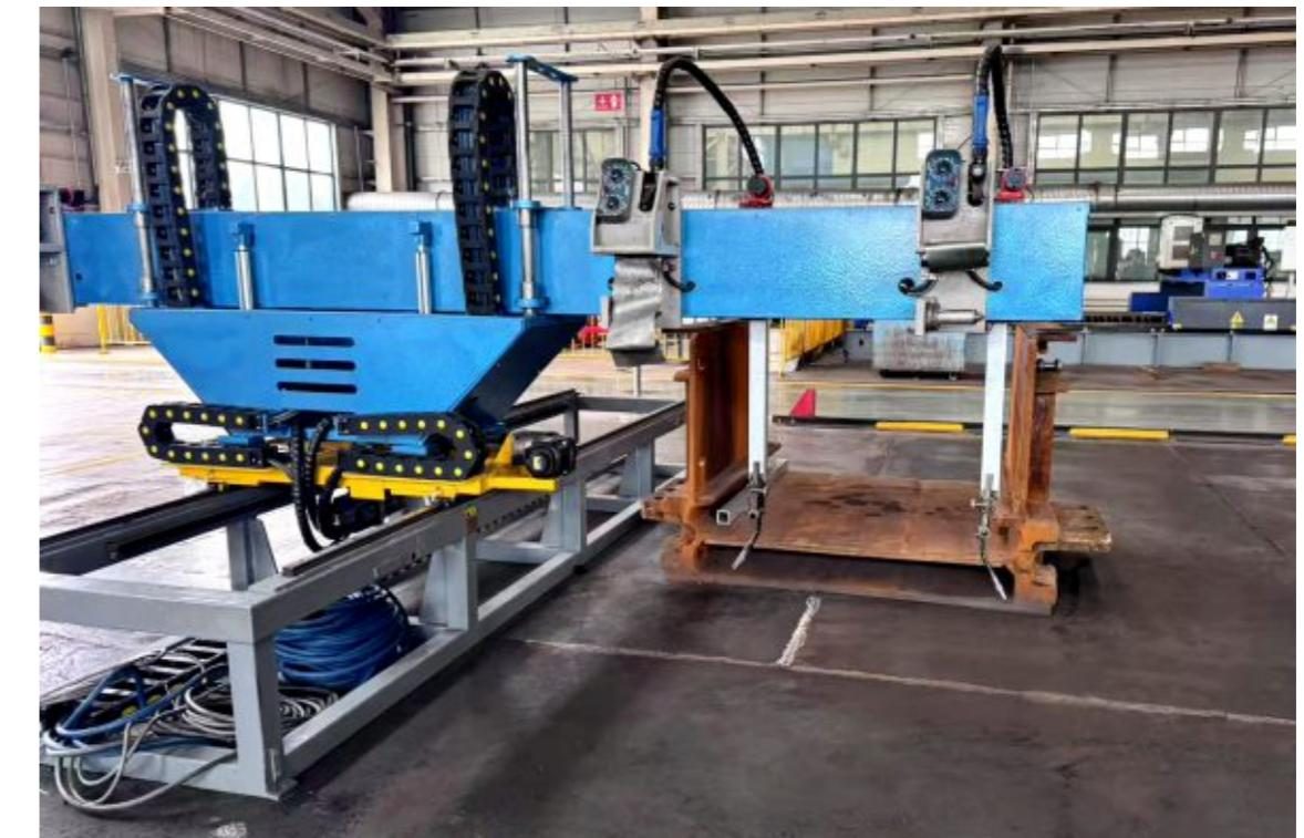
近日，生产服务中心自主研发的多功能全自动悬臂焊机经实际应用检验后正式投入使用，有效提高了生产效率，降低了劳动强度，进一步提升了焊接质量稳定性。
