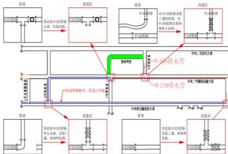
具体内容：孟村矿创新实施井下“排水系统一张图”工程，全面排查井下排水系统，摸排井下排水点32处，同步更新涌水水源、排水管线、水泵配置和责任单位等信息。针对中央大巷排水系统，通过优化7#联巷排水点排水管线，调整水沟路径，将涌水集中引流至强排水仓。同时，回填该排水点并施工地坪，释放巷道空间，实现局部环形通车。
