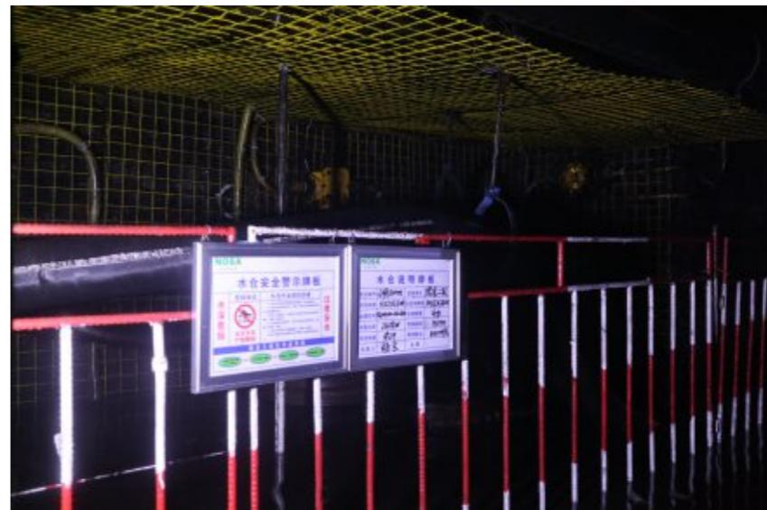
具体内容：根据采煤工作面巷道层位特征和水仓布置情况，工作面回采前只在巷道最里侧2个水仓安装水泵，在回采过程中随里侧水仓进入切眼位置，将仓内水泵移至外段水仓进行安装，形成迈步式排水系统。4034上09工作面两巷共10个水仓，每个水仓计划安装6台水泵，共计60台。回采前在巷道最里侧2个水仓安装水泵，减少使用6个水仓36台水泵，降低生产成本。
