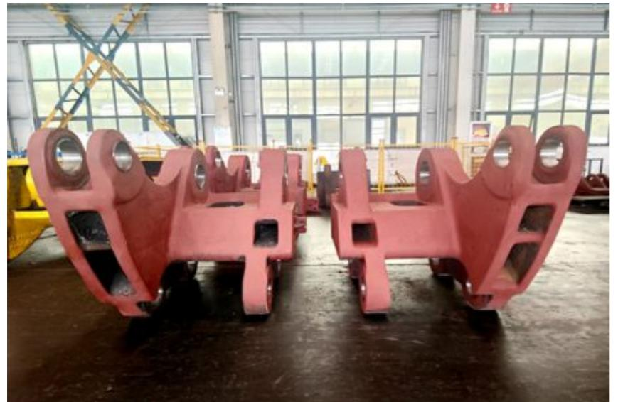
具体内容：针对采煤机关键部件摇架更换成本高、采购周期长的痛点，生产服务中心在维修MG500/1330-AWD型号采煤机过程中，精准识别可用资源，从矿方同型号淘汰设备上拆卸旧摇架，通过严格的修复、焊接、加工、镶套等工艺进行再生处理，成功替代新件用于设备维修，不仅有效盘活了闲置资产，更缩短了设备维修周期。
